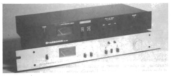
Il DL 506 può essere usato anche come **espansore di dinamica**, con un rapporto fisso di espansione. 1 : 2, per l'ascolto di dischi e di emissioni radiofoniche. L'apparecchio è disponibile in due versioni di diverse dimensioni: con pannello da 420 mm o da 482 mm, per l'inserimento in mobili rack standard da 19". Sono disponibili anche due diversi colori: nero o in alluminio naturale.
